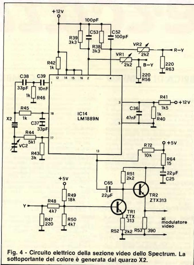
Fig. 4 - Circuito elettrico della sezione video dello Spectrum. La sottoportante del colore è generata dal quarzo X2.
