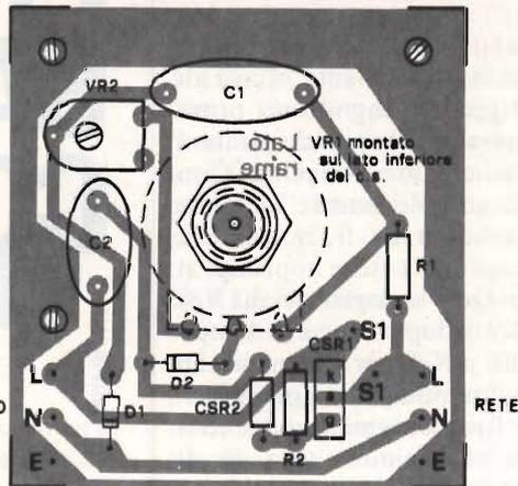
Fig. 4 - Disposizione dei componenti sulla bassetta stampata.
