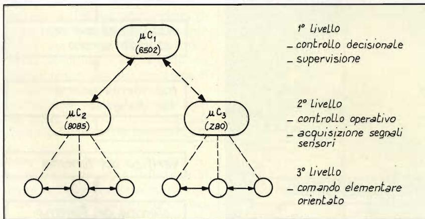
**Ecco i tre microprocessori utilizzati per il sistema GILBERTO, capaci di controllare il movimento di un manipolatore automatico. Come si può vedere dallo schema, tutto il sistema è collegato in modo semplice. Le diverse caratteristiche delle CPU fanno assumere al sistema una struttura piramidale scissa in due livelli gerarchici ben distinti tra loro.**
