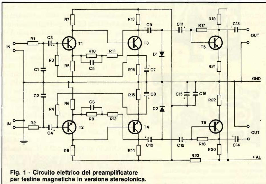
**Fig. 1 - Circuito elettrico del preamplificatore per testine magnetiche in versione stereofonica.**
