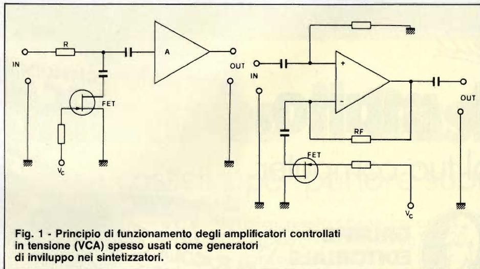
Fig. 1 - Principio di funzionamento degli amplificatori controllati in tensione (VCA) spesso usati come generatori di inviluppo nei sintetizzatori.
