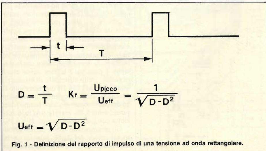
Fig. 1 - Definizione del rapporto di impulso di una tensione ad onda rettangolare.
