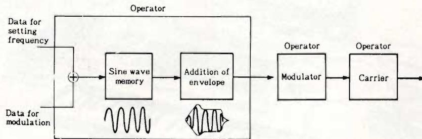
Fig. 2 - Schema a blocchi del sistema di modulazione.
