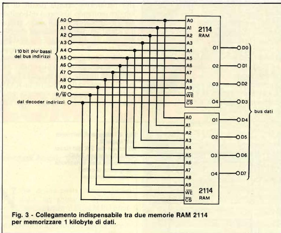
Fig. 3 - Collegamento indispensabile tra due memorie RAM 2114 per memorizzare 1 kilobyte di dati.
