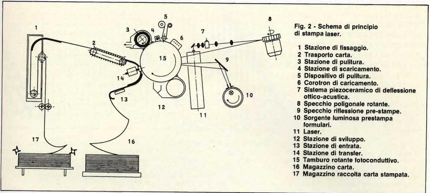
Fig. 2 - Schema di principio di stampa laser.
