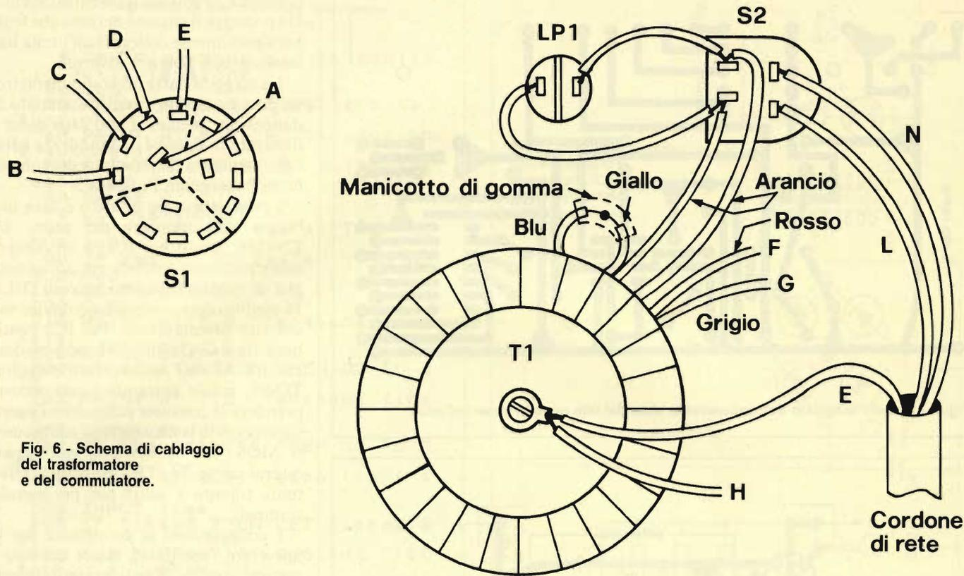
Fig. 6 - Schema di cablaggio del trasformatore e del commutatore.
