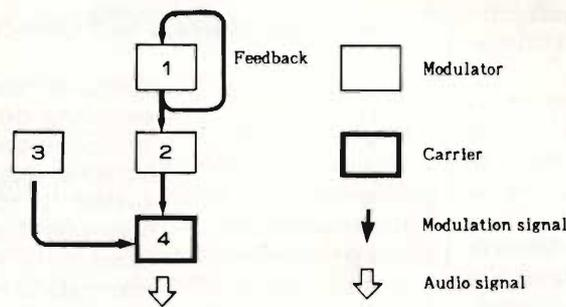
Fig. 3 - Diagramma di flusso della modulazione strumentale.
