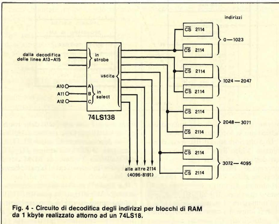
Fig. 4 - Circuito di decodifica degli indirizzi per blocchi di RAM da 1 kbyte realizzato attorno ad un 74LS138.
