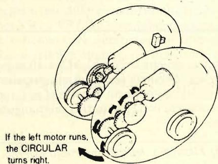
**Fig. 4 - Così si muove il Circular.**
