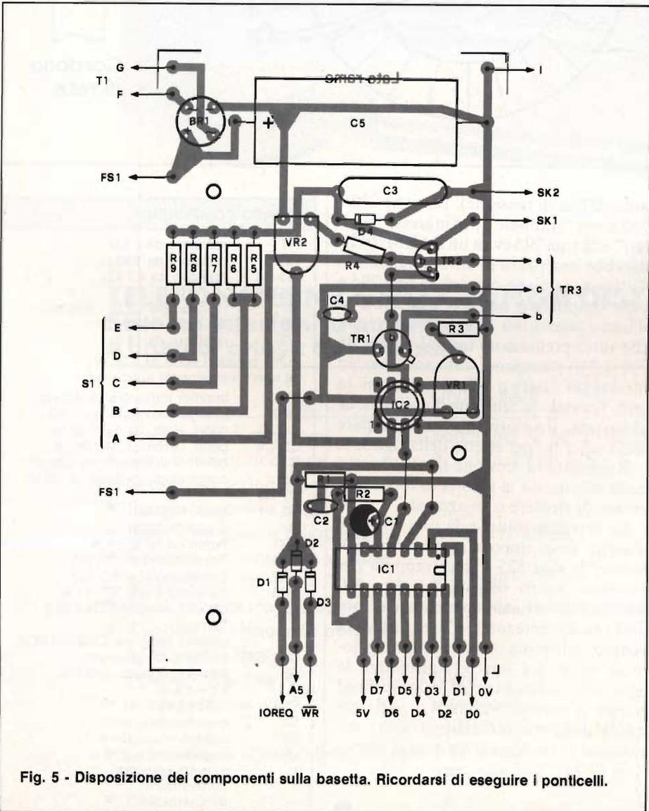
Fig. 5 - Disposizione dei componenti sulla basetta. Ricordarsi di eseguire i ponticelli.
