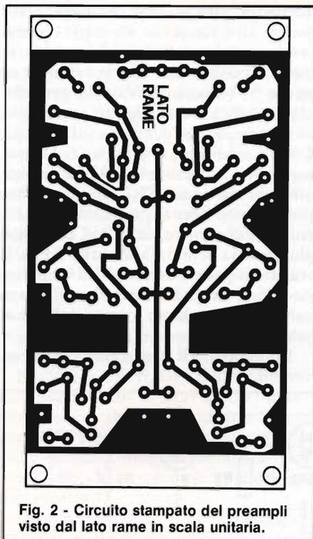
Fig. 2 - Circuito stampato del preamplificatore visto dal lato rame in scala unitaria.
