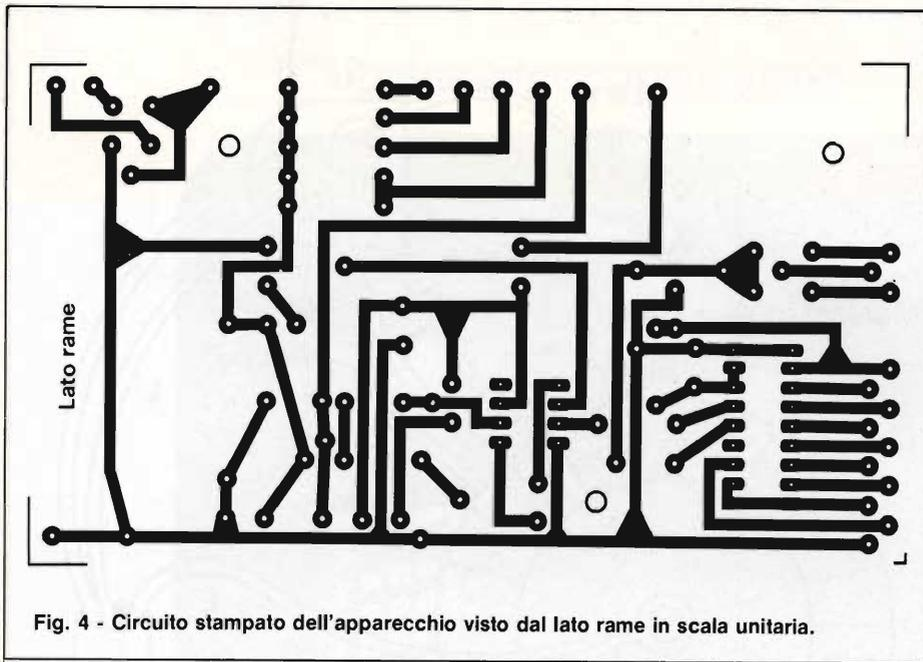
Fig. 4 - Circuito stampato dell'apparecchio visto dal lato rame in scala unitaria.
