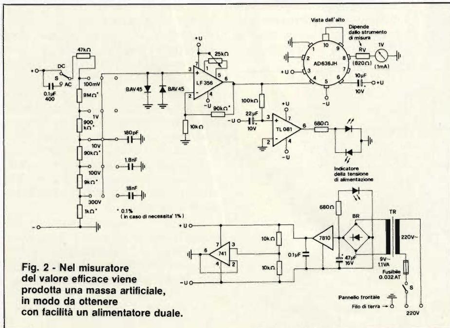
**Fig. 2 - Nel misuratore del valore efficace viene prodotta una massa artificiale, in modo da ottenere con facilità un alimentatore duale.**
