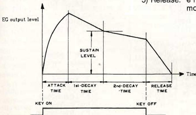
Fig. 4 - Parametri caratteristici di un involuppo; vengono evidenziati: l'Attacco, il Sustain ed il Release.
