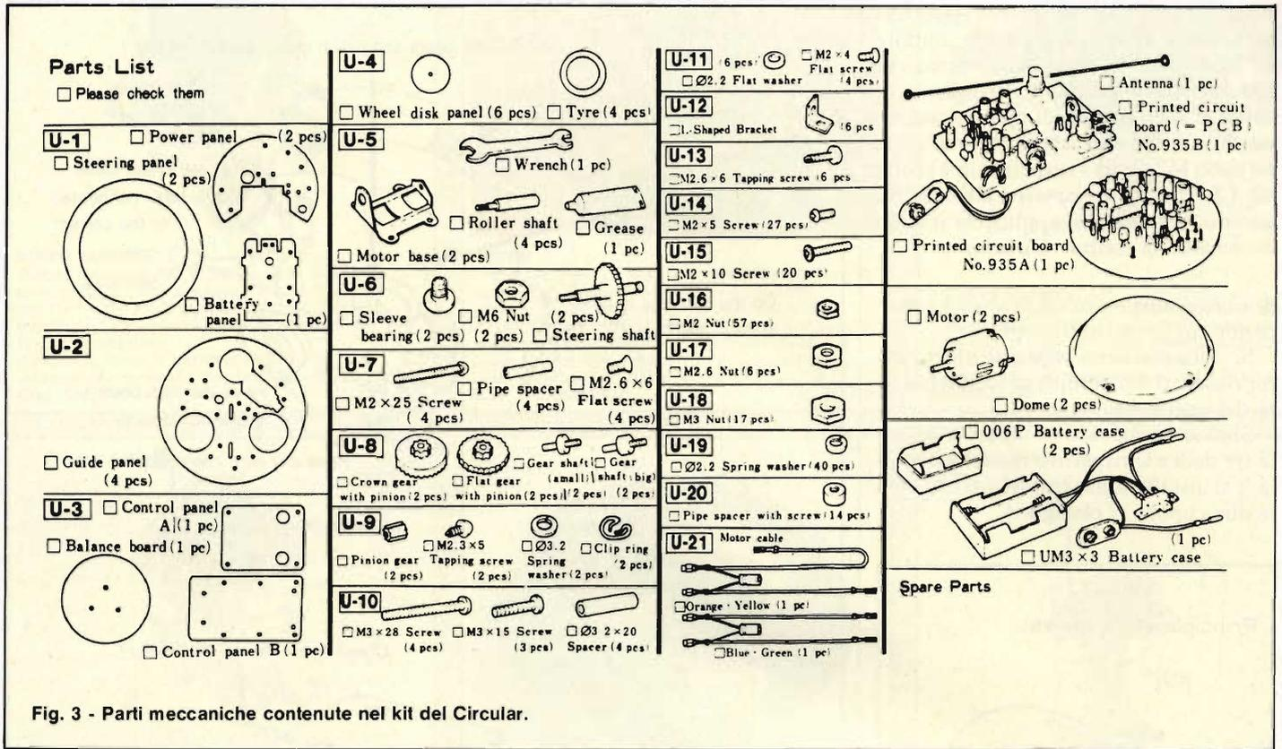
Fig. 3 - Parti meccaniche contenute nel kit del Circular.
