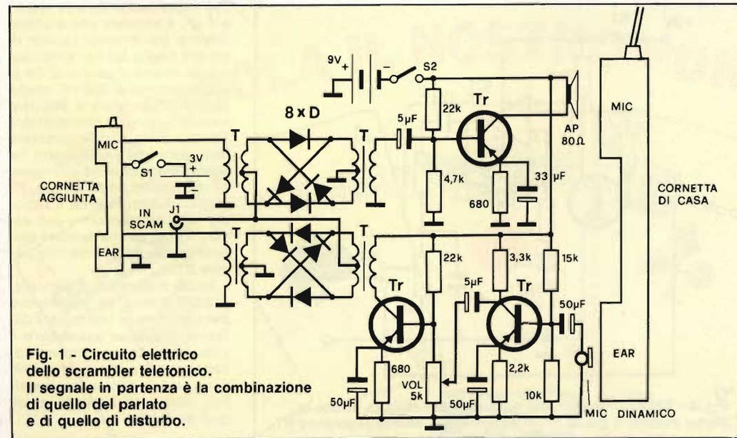
Fig. 1 - Circuito elettrico dello scrambler telefonico. Il segnale in partenza è la combinazione di quello del parlato e di quello di disturbo.
