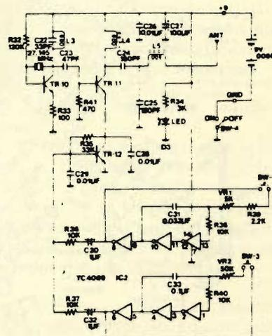
Fig. 1 - Lo schema elettrico del trasmettitore (a destra) e del ricevitore (a sinistra) del telecomando del Circular.
