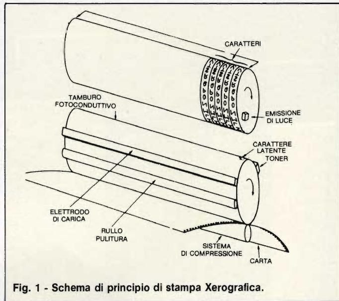
Fig. 1 - Schema di principio di stampa Xerografica.
