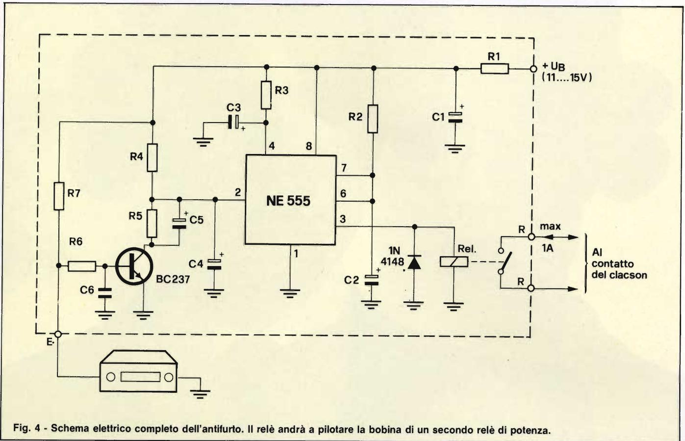
Fig. 4 - Schema elettrico completo dell'antifurto. Il relè andrà a pilotare la bobina di un secondo relè di potenza.
