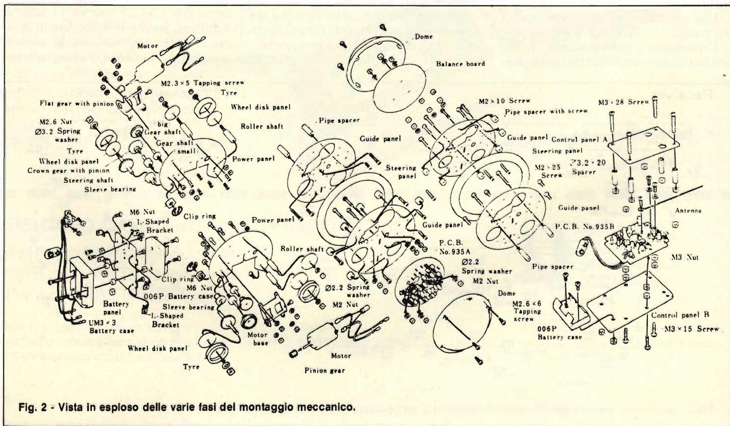
Fig. 2 - Vista in esplosione delle varie fasi del montaggio meccanico.
