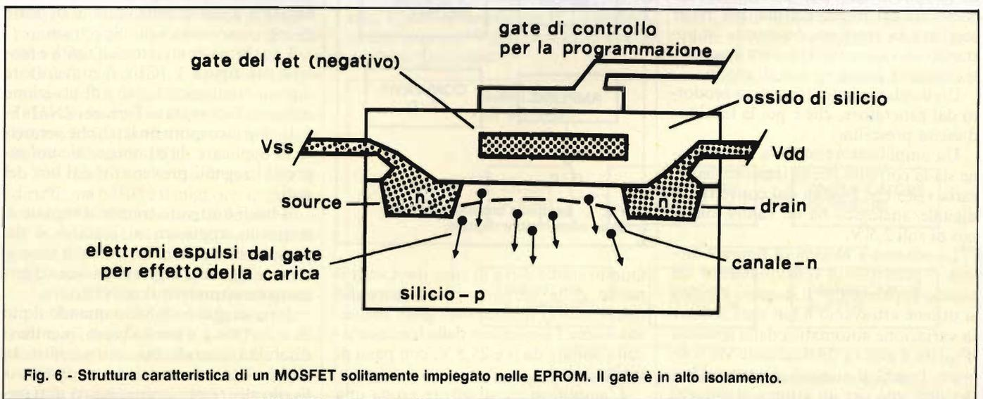
Fig. 6 - Struttura caratteristica di un MOSFET solitamente impiegato nelle EPROM. Il gate è in alto isolamento.
