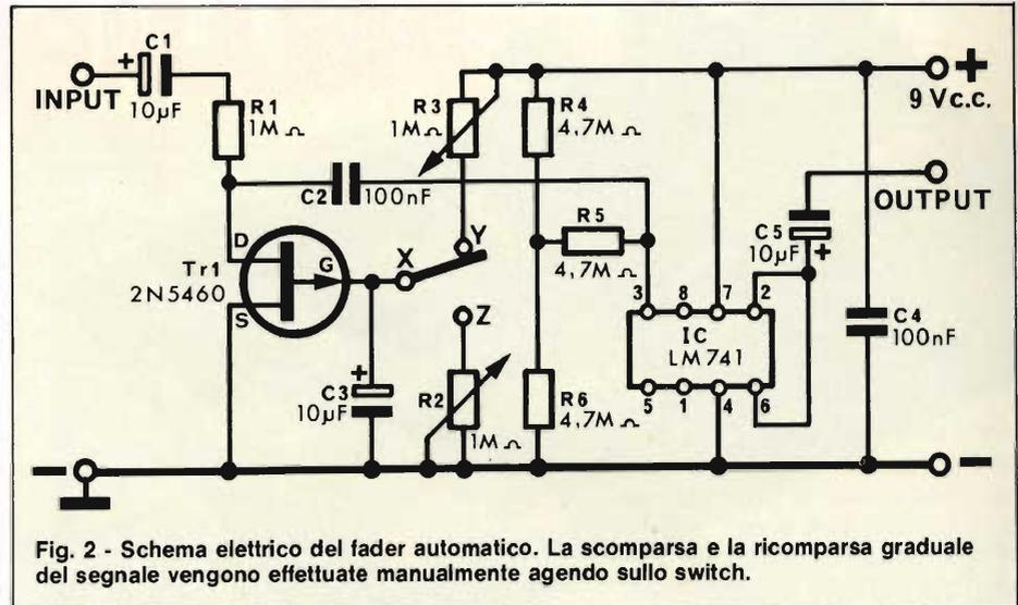
Fig. 2 - Schema elettrico del fader automatico. La scomparsa e la ricomparsa graduale del segnale vengono effettuate manualmente agendo sullo switch.
