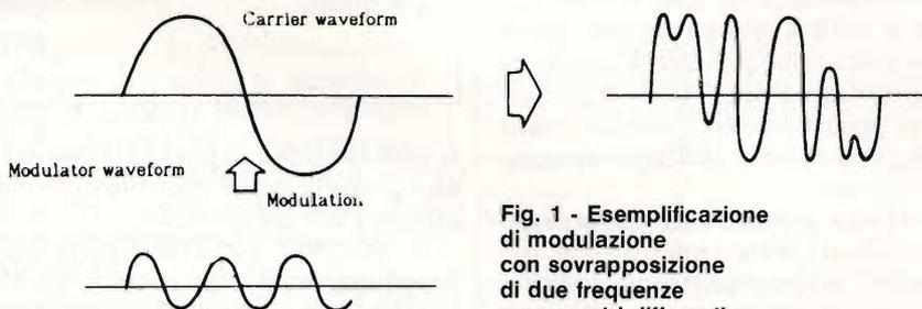
Fig. 1 - Esempificazione di modulazione con sovrapposizione di due frequenze a parametri differenti.
