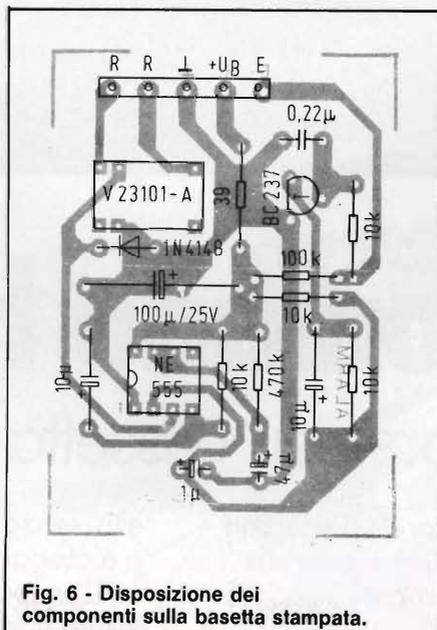
Fig. 6 - Disposizione dei componenti sulla basetta stampata.
