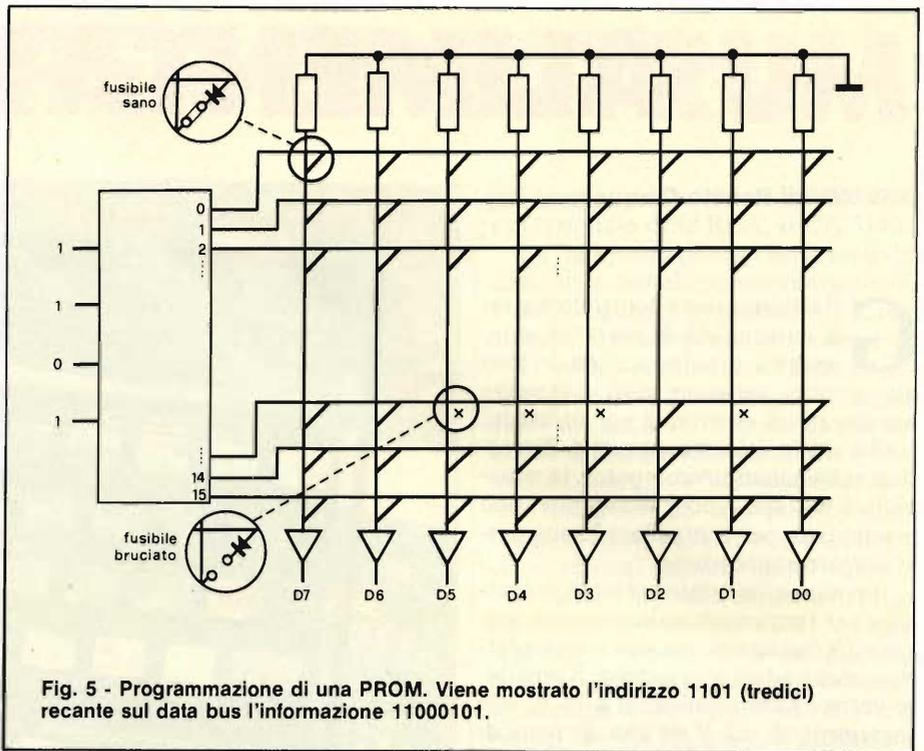
Fig. 5 - Programmazione di una PROM. Viene mostrato l'indirizzo 1101 (tredici) recante sul data bus l'informazione 11000101.
