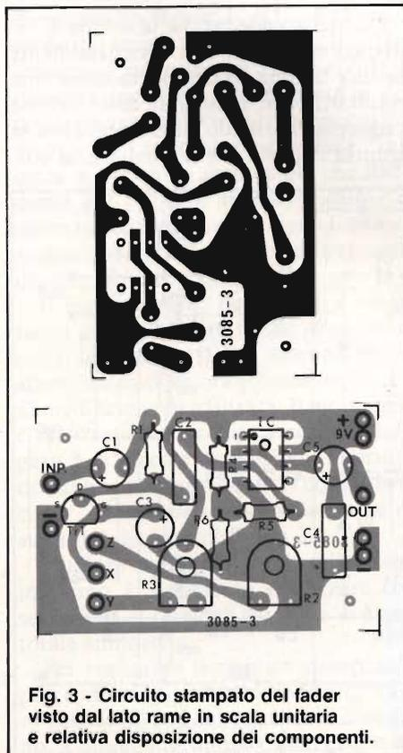
Fig. 3 - Circuito stampato del fader visto dal lato rame in scala unitaria e relativa disposizione dei componenti.
