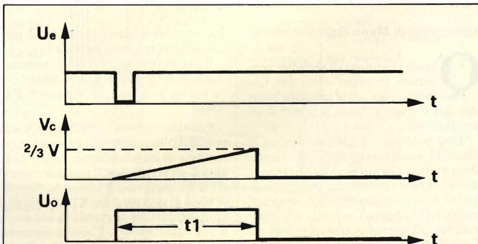
Fig. 3 - Andamento delle tensioni del circuito in funzione del tempo.
