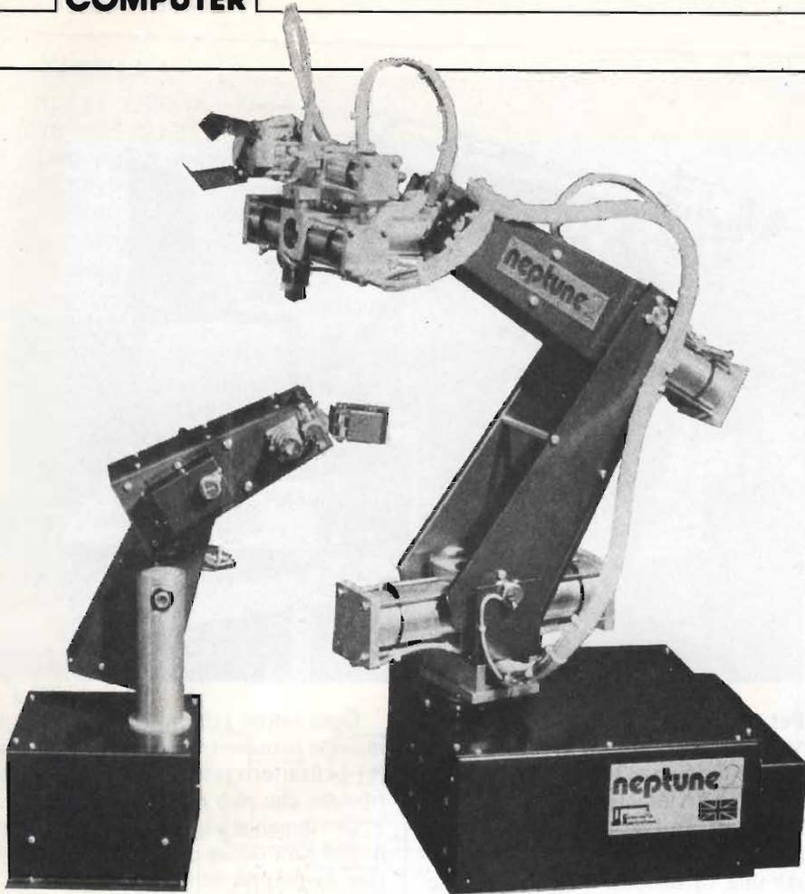
Richard Becker per quanto riguarda il design e la parte meccanica e Tim Orr per quanto concerne l'interfaccia computer e l'elettronica di controllo, hanno messo a punto una coppia di robot interfacciabili con lo ZX Spectrum della Sinclair, con il VIC 20 della Commodore e con tutti i computer BBC.
