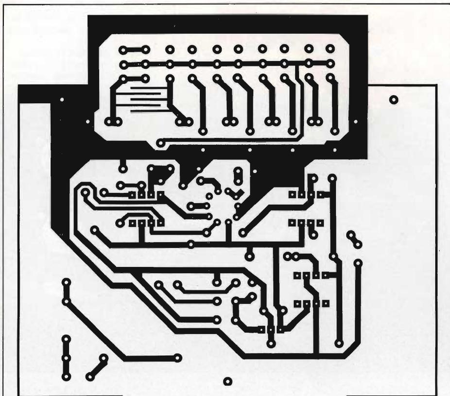
Fig. 3 - Circuito stampato del Voltmetro elettronico visto dal lato rame in scala unitaria.
